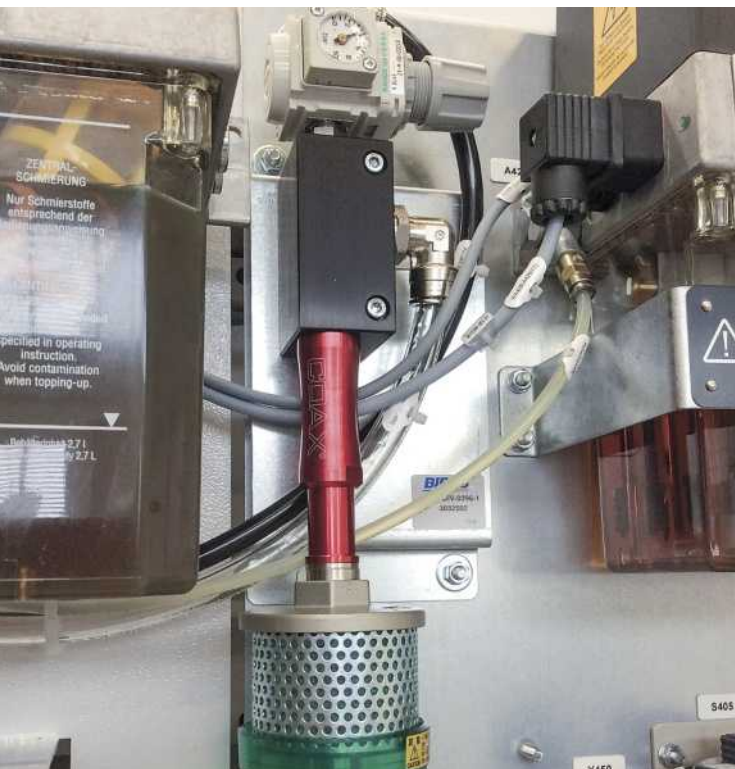
Eine optimierte Düse zur Absaugung des Öl-Luft-Gemischs in der Werkzeugspindel verbraucht rund 57% weniger Druckluft als zuvor
