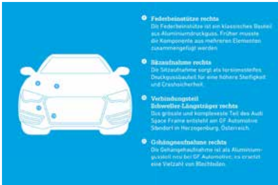
Mit seinen Komponenten trägt GF Automotive entscheidend zum intelligenten Leichtbaukonzept des neuen A8 bei
