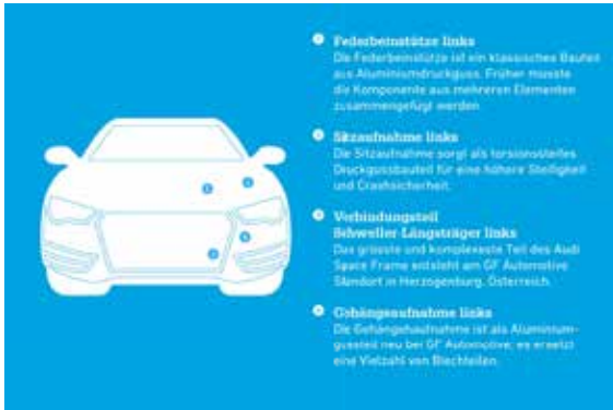
Für den Audi Space Frame des neuen A8 liefert GF Automotive elf ultraleichte Gussteile aus Aluminium und Magnesium – so viele wie nie zuvor
