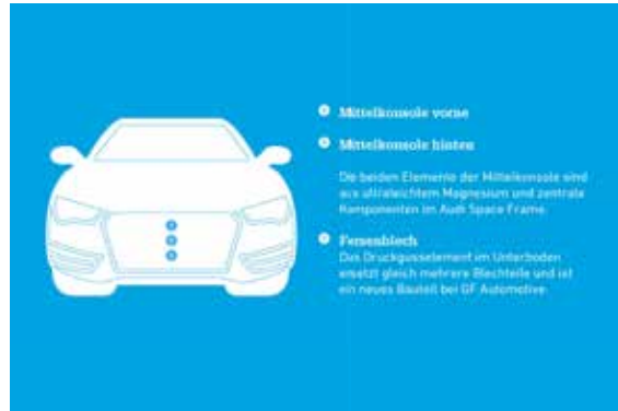
Dank des Audi Space Frame wiegt die Karosserie des A8 gut 40% weniger als eine vergleichbare Konstruktion aus Stahl
